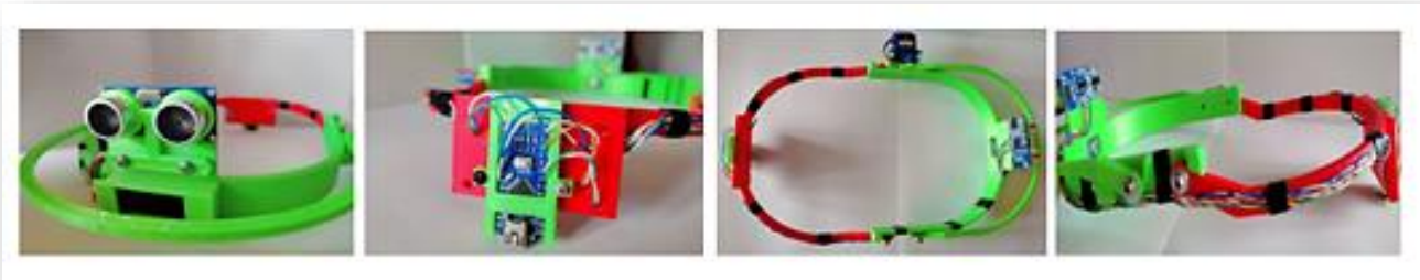
Prototipo: Careta automática de protección activada por proximidad
